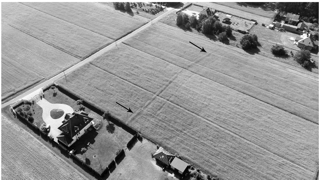
Ryc. 3. Dzierzgówek, gm. Nieborów. Wyróżnik wegetacyjny wskazujący przebieg gazociągu na odcinku Łowicz – Skierniewice
