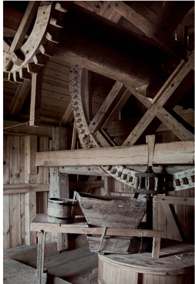
■ Maszyna wiatraka kozłowego ■ The machinery of the trestle windmill
